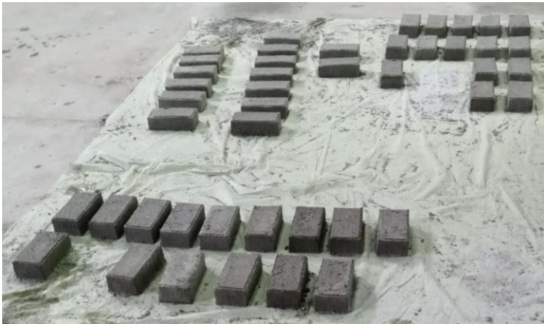
Gambar 112. Pengolahan Limbah Kerja Batu Menjadi Paving Block
