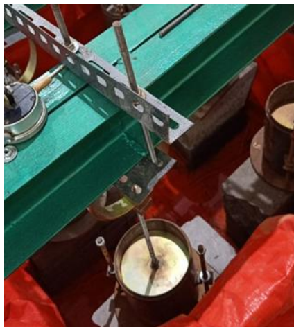
Gambar 3.8. Pengujian Pengembangan dengan modified mould dengan CBR
