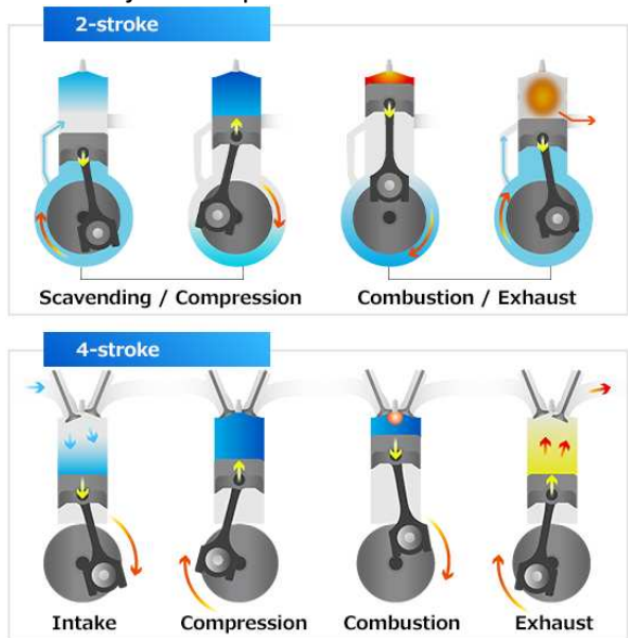
Gambar 4.10 Perbandingan siklus 4 dan 2 langkah tak [5]
