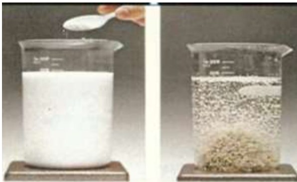
Gambar 3.1 Pengolahan Air Secara Koagulasi
